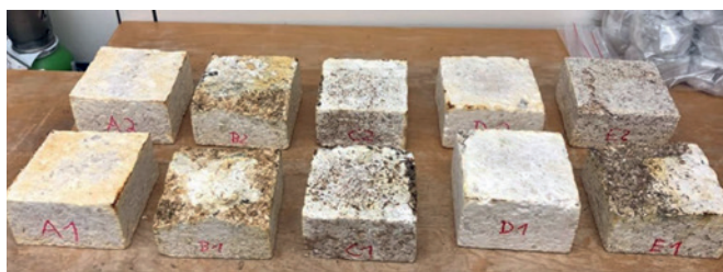
Versuchskörper zur Ermittlung der Wärmeleitfähigkeiten
