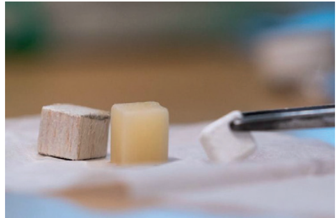
Natürliches Holz (l.) und delignifiziertes Holz (r.) – durch die Entfernung von Lignin aus Holz wird es farblos
